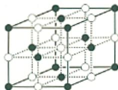
1個のイオンに最も近い距離にある同符号のイオンは12個(1個の○は12個の○に囲まれ、1個の●は12個の●に囲まれている)。また、単位格子中には、○と●がそれぞれ4個ずつ含まれており、○と●の組成の比は1:1である。
